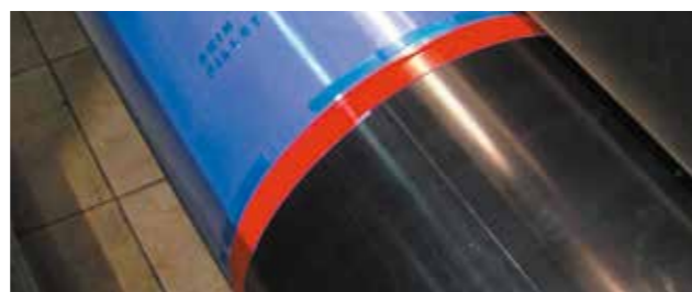
Герметизация края флексоформы лентой 3M™ Scotch® 6893
